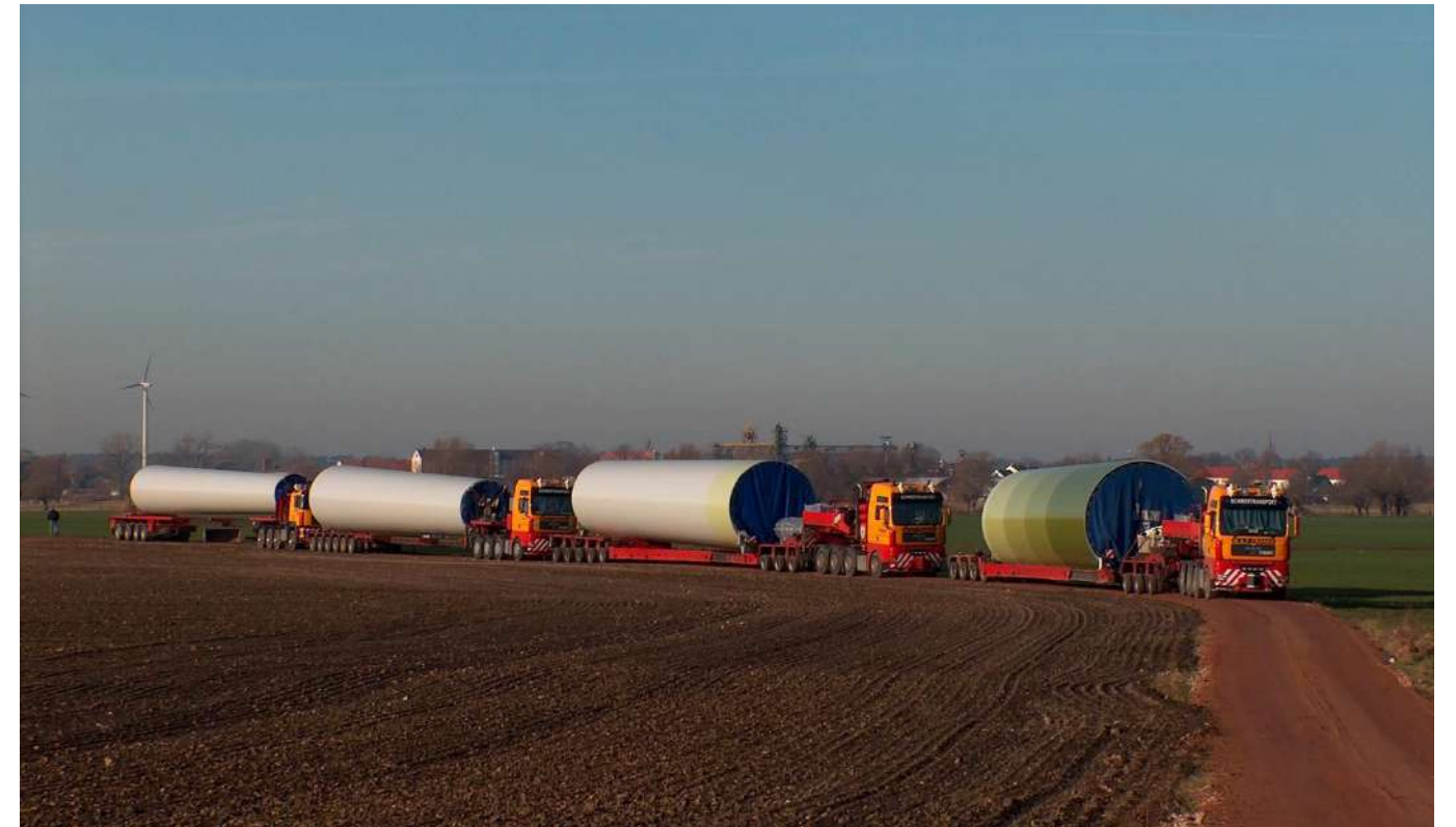
Transport d'une section de mât d'éolienne (Source : ENERCON)
